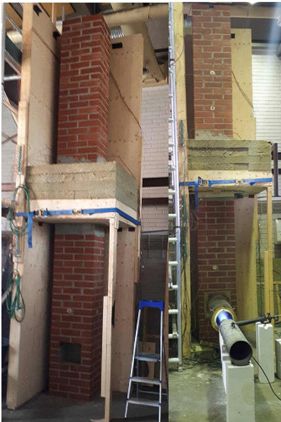
Kuva 3 Savupiippu, välipohjarakenne (koekappale) ja koejärjestely
